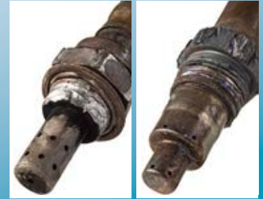
Uszkodzona sonda lambda
